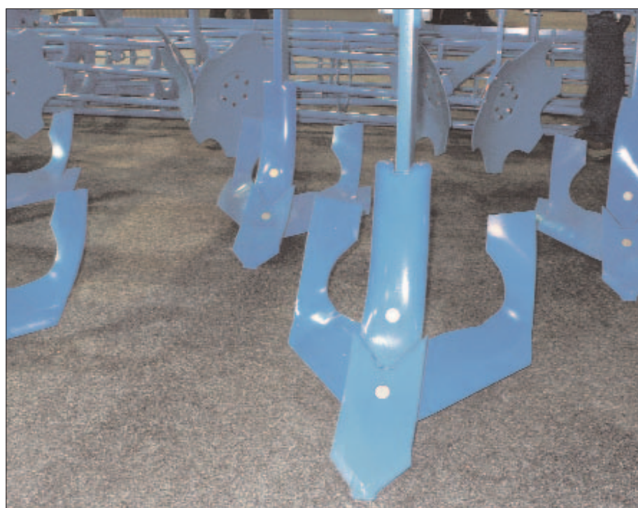
Das innovative TriMix-Flügelschar an der neuen Grubbergeneration von LEMKEN sorgt für eine deutlich intensivere DEurchmischung bei der Stoppelbearbeitung...
