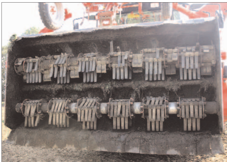
Der Entblättern im Frontanbau des Maxtron kommt mit zwei Wellen aus. Oben die Multiwelle, unter die Putzerwelle.
