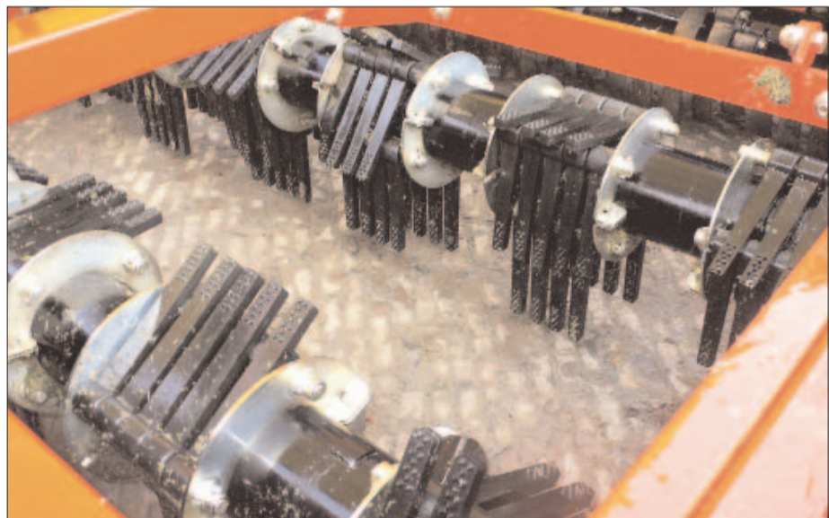
Der BM 300 ist mit einer Multiwelle (im Bild mit Stahlschlegeln rechts vorne) und zwei gegenläufigen Putzerwellen (hier noch mit noppierten Polyurethanschlegeln) ausgerüstet; diese müssen imstande sein, die Rüben „sanft“ zu entblättern, um Verletzungen am Rübenkörper zu vermeiden. Schlegel aus Naturkautschuk ohne Noppen scheinen geeignet, sind allerdings verschleißanfälliger.
